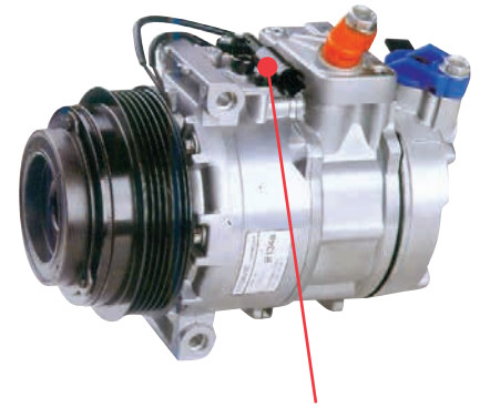
Variable Verdichtung am Beispiel des Kompressors
